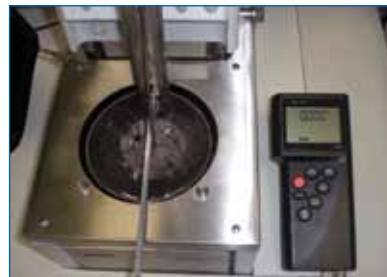
Kalibrierung bei 0°C Calibration at 0°C.
