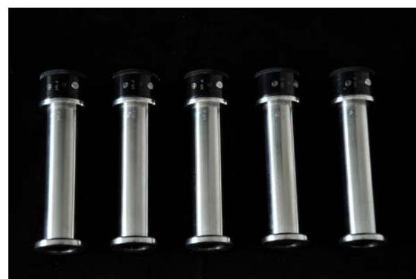
Rys. 1. Państwowy wzorzec jednostki kąta skręcenia płaszczyzny polaryzacji światła
