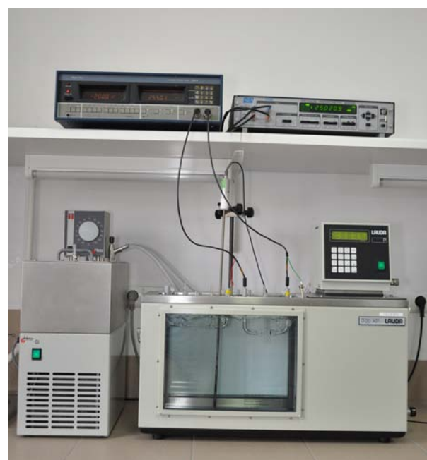
Rys. 2. Stanowisko pomiarowe w Laboratorium Elektrochemii GUM do wzorcowania naczyń konduktometrycznych i wtórnych konduktometrycznych materiałów odniesienia
