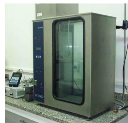
Rys. 5. Stanowisko pomiarowe (S03) do wzorcowania wzorców lepkości cieczy w zakresie temperatur: (25 ± 80) °C
