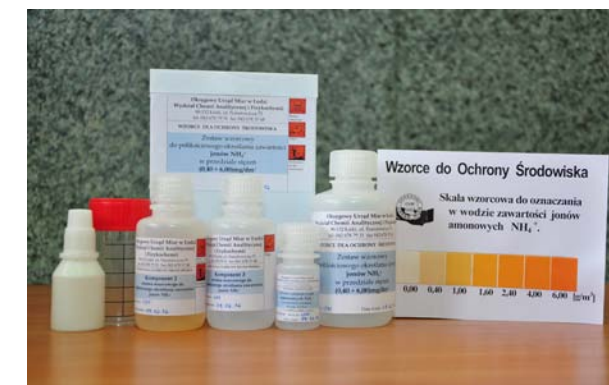
Rys. 12. Zestaw do określania zawartości jonów amonu \text{NH}_4^+ w wodzie lub ściekach
