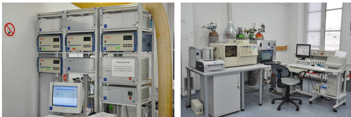
Rys. 2. Stanowiska do sprawdzania i wyznaczania zawartości składników w mieszaninach gazowych
