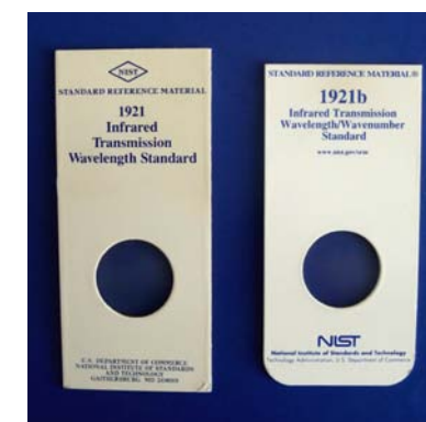
Rys. 2. Spektrofotometryczne wzorce odniesienia: NIST SRM 1921 i 1921b dla zakresu podczerwieni
