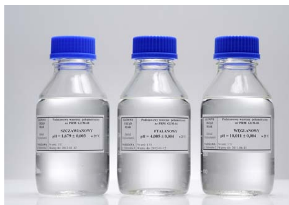
Rys. 2. Pierwotne materiały odniesienia pH sporządzane i wzorcowane w Laboratorium Elektrochemii GUM
