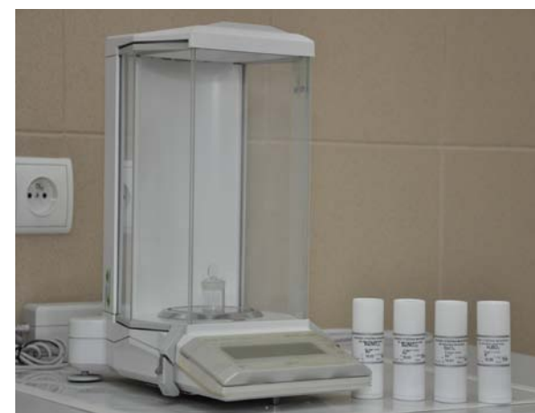
Rys 2. Waga analityczna klasy dokładności I wraz z wzorcami stężenia masowego do ASA
