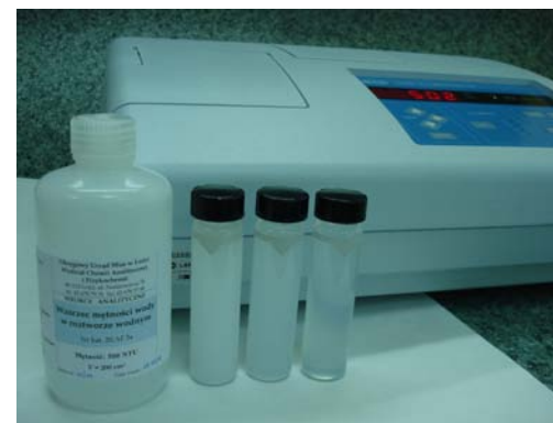
Rys. 11. Stanowisko do pomiaru mętności oraz wzorzec mętności wody
