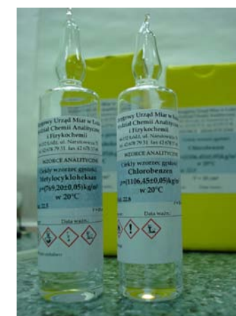
Rys. 16. Ciekłe wzorce gęstości wytwarzane w Okręgowym Urzędzie Miar w Łodzi
