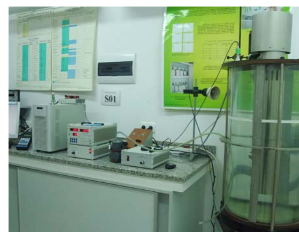
Rys. 4. Stanowisko pomiarowe (S01) wzorca odniesienia jednostki miary lepkości do wzorcowania wzorcowych wiskozymetrów kapilarnych szklanych i wzorców lepkości cieczy w temperaturze 20 °C
