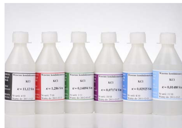
Rys. 3. Wtórne konduktometryczne materiały odniesienia sporządzone i wzorcowane w Laboratorium Elektrochemii GUM
