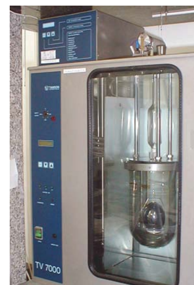
Rys. 6. Wyznaczanie gęstości cieczy na stanowisku ważenia hydrostatycznego
