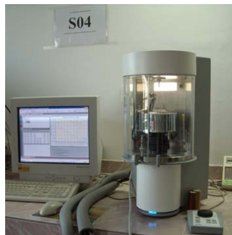
Rys. 2. Tensjometr K100 z pierścieniem platynowym i płytką, firmy Krüss
