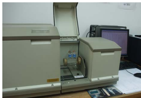
Rys. 3. Stanowisko pomiarowe do wzorcowania spektrofotometrycznych wzorców liczb falowych (długości fal) dla zakresu podczerwieni: spektrofotometr IR-SPECTRUM 2000 wraz z jednostką sterującą
