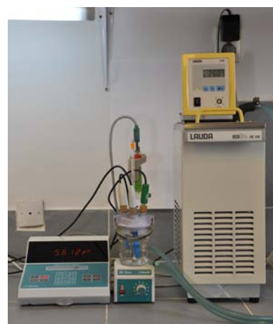
Rys. 1. Stanowisko pomiarowe do wzorcowania wtórnych materiałów odniesienia pH za pomocą ogniwa z elektrodą szklaną w Laboratorium Elektrochemii GUM
