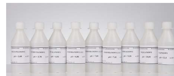
Rys. 2. Wtórne materiały odniesienia pH sporządzane i wzorcowane w Laboratorium Elektrochemii GUM
