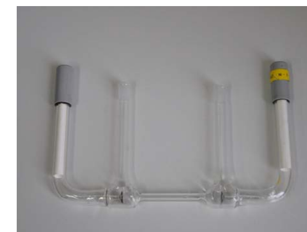
Rys. 1. Naczynie konduktometryczne typu Jonesa (dwuelektrodowe) stosowane do wzorcowania wtórnych konduktometrycznych materiałów odniesienia w Laboratorium Elektrochemii GUM
